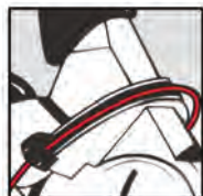
Biegen des Labialaußenbogens Bending of labial outer bows
